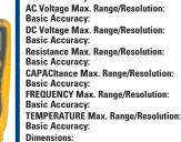
IA195 1000A/10mA ±2.5% rdg. ±5 dgt. 1000A/10mA ±3.0% rdg. ±4 dgt. 600V/0.1mV ±0.8% rdg. ±2 dgt. 600V/0.1mV ±1% rdg. ±4 dgt.  $40M\Omega < None > /0.1\Omega$ ±1.0% rdq. ±4 dqt. 40uF/0 01nF ±3.0% rdg. ±5 dgt. 10MHz/0.01MHz ±1.2% rdg. ±3 dgt. 1000°C (1832°F)/ 1°C(°F) ±3.0% rdq. ±5 dqt. 229 H x80 W x 49 D (mm) Approx. 303 q
